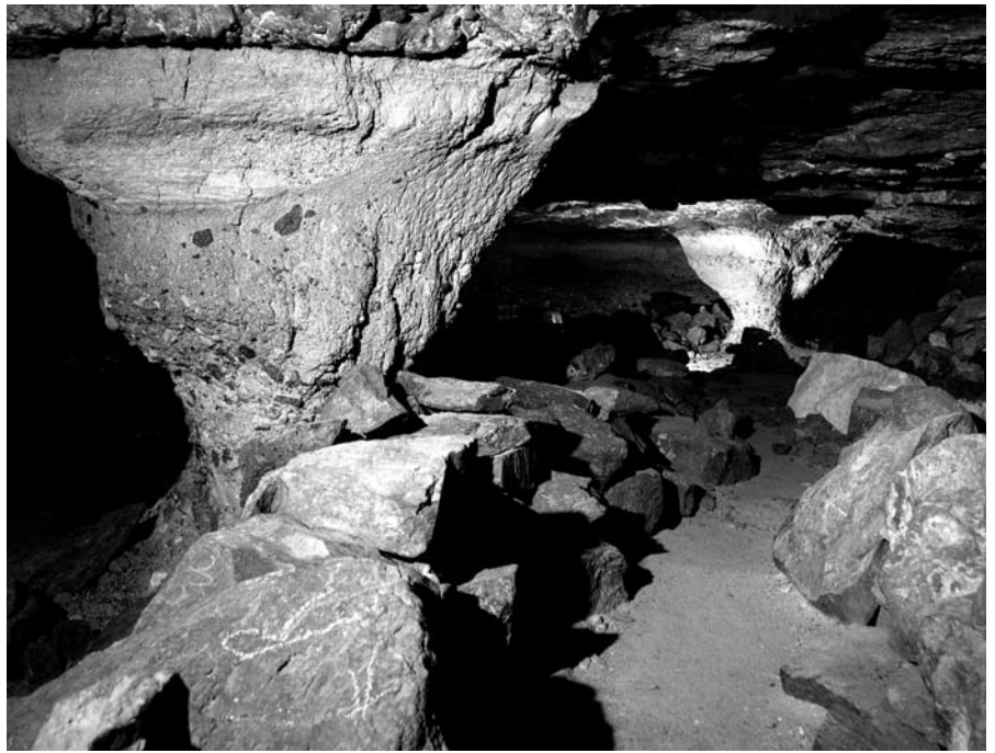
Fig. 16 - Ani, Turchia orientale. Assottigliamento di pilastri in una miniera di ossidiana (foto: R. Bixio - Centro Studi Sotterranei). La tipica scheggiatura che si genera lungo le pareti dei pilastri è causata dai carichi verticali esercitati dal peso delle rocce sovrastanti.
