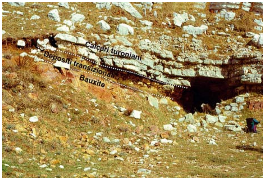
Fig. 3 - Miniere di bauxite, Cusano Mutri (Monti del Matese - Campania). La stratigrafia in affioramento mette ben in evidenza il livello mineralizzato in corrispondenza del quale si apre l'ingresso della miniera (foto: F. Allocca, archivio S. Del Prete).
