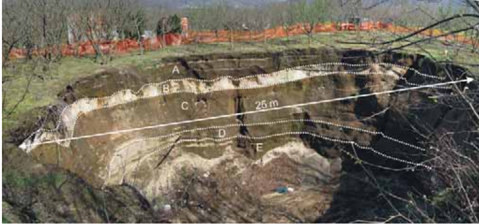
Fig. 2 - Panoramica della stratigrafia visibile lungo le pareti del sinkhole di Contrada Petrosa (foto del marzo 2007). Legenda: A) suoli recenti con due livelli di eruzioni vulcaniche storiche [472d.C. e 1631]; B) pomici dell'eruzione vulcanica di Mercato/Ottaviano, 8000 anni fa; C) cineriti rimaneggiate (limi sabbiosi) con pomici e locali livelli di sabbie e paleosuoli; D) pomici grigie e scorie probabilmente riferibili all'eruzione di Sarno rimaneggiate in ambiente alluvionale; E) cineriti (limi sabbiosi) pedogenizzate con locali livelli di sabbie fini.
